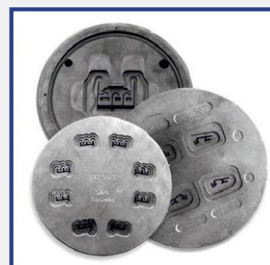
Matryce do wyciskania cienkościennych profili aluminiowych
