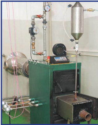
Modelowe stanowisko badawcze do współspalania odpadów stałych z odpadami konwencjonalnymi
