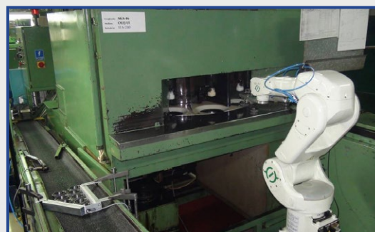
Manipulator wieloosiowy obsługujący automatyczne stanowisko mycia i konserwacji łożysk tocznych
