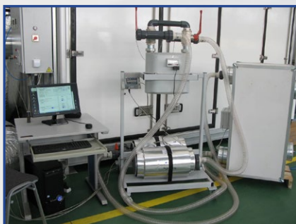
Urządzenie do badania szczelności central wentylacyjnych z odzyskiem ciepła
