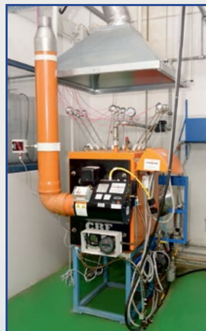
Modelowe stanowisko do badania procesów spalania paliw ciekłych zawierających glicerynę
