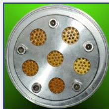
Moduł membranowy z zamocowanymi rurowymi membranami ceramicznymi
