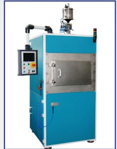
Urządzenie do badań zużycia erozyjnego
