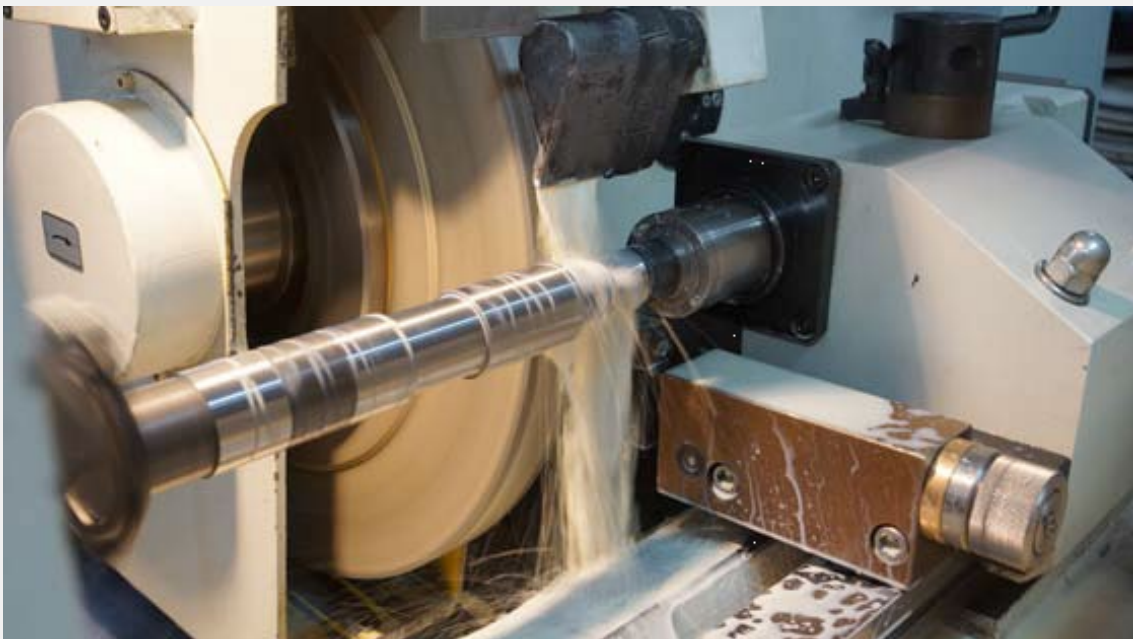
Szlifowanie zregenerowanego czopa łożyska ślizgowego
