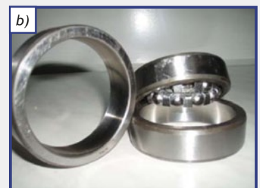
Test EMCOR: a) stanowisko badawcze, b) zewnętrzna bieżnia pierścieni badanych łożysk pracujących w obecności smaru SILFA
