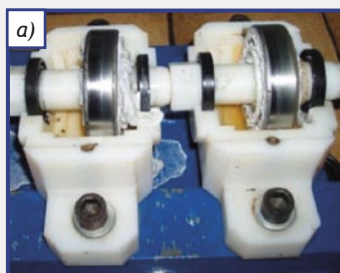
Test EMCOR: a) stanowisko badawcze, b) zewnętrzna bieżnia pierścieni badanych łożysk pracujących w obecności smaru SILFA
